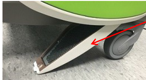
Фигура 69: Достъп до долния въздушен филтър
