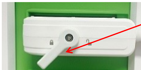
Фигура 21: Ориентация на конектора на трансдюсера
