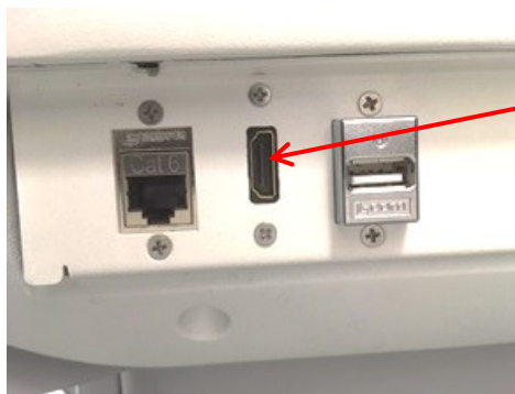
Фигура 11: HDMI конектор за втори монитор
